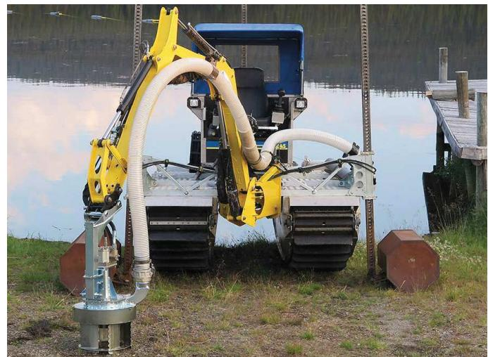
Doro pumpa V3 kada se montira na Doro bager nudi opsežnu kontrolu nad dodacima za jaružanje. Sustav ima rotirajuću glavu i noževe montirane na usisu, osiguravajući ravnomjerno dopremanje materijala u Doro pumpu.
