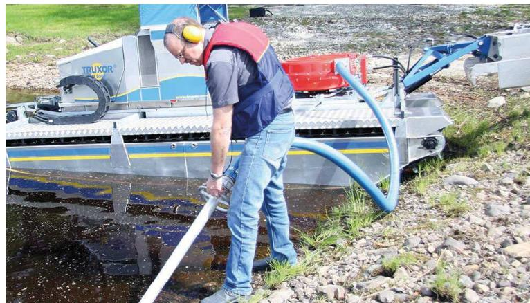
Sala Roll pump je pumpa pogodna za dekontaminaciju nepristupačnih zagađenih predjela. Usisna cijev može se postaviti na Doro Skimmer ili koristiti ručno.
