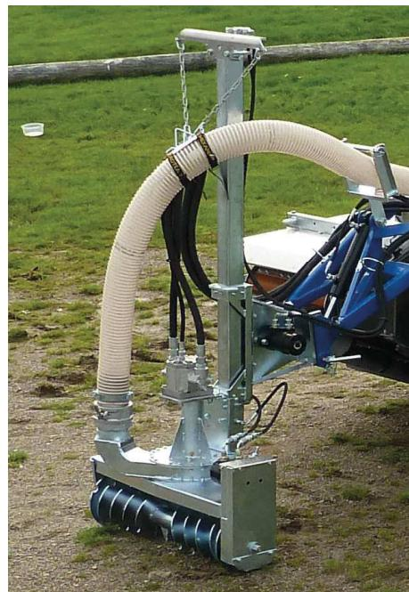
Doro pumpa ima hidraulični pogon. Vijak ubacuje talog u pumpu gdje se nalaze noževi koji omogućuju neprekidan protok taloga. Doro pumpa se lako montira, a izmjena drugog alata zahtjeva svega nekoliko minuta.
