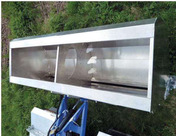
Materijali koji apsorbiraju ulje lako se razbacuju s Doro posipačem DM 1000. Apsorbenti se rasporede po izlivenom ulju kako bi se ograničila šteta i olakšalo sakupljanje ulja u vodi. Rotirajuća glava za rasipanje kontrolira se s vozačevog sjedala i olakšava nanošenje odgovarajuće količine upijača. Središnja pregrada u spremniku omogućuje korištenje polovice radne širine. Doro posipač DM 1000 može se koristiti s većinom vrsta apsorbenata.
