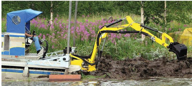
Kopač Doro je bagerska ruka za iskop i kombinirani sustav za pričvršćivanje drugih alata. Bagerska je ruka izrađena od čelika visoke čvrstoće i ima ugrađene nosače za pričvršćivanje crijeva jaružala i dodatnih hidrauličkih cijevi.
