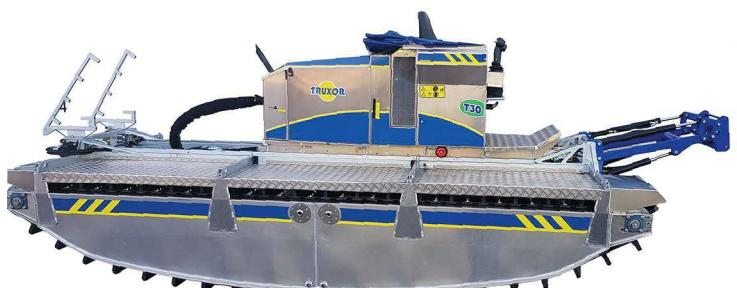
Pokretna kabina se hidraulički podešava i može poslužiti za balansiranje stroja (po principu kontra utega).
