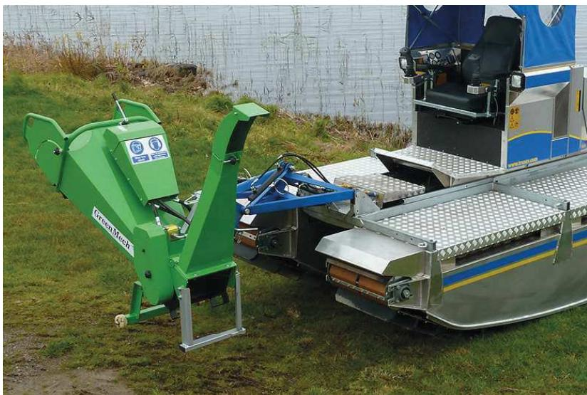
Ima ugrađena dva noža. Rotor uvlači materijal unutra, a protok zraka usmjerava materijal dalje kroz podešen izlaz. Radi uz pomoć hidraulike i na podesivom je nosaču, što olakšava rad na kosinama. Pokazao se koristan kod raščišćavanju močvara, jezera i kanala.
