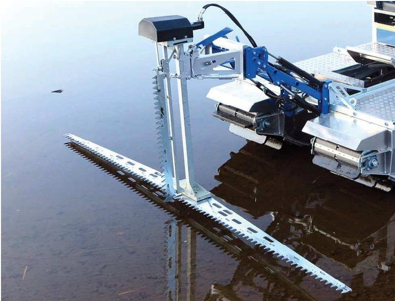
Doro cutter D20 savršeno je rješenje za uobičajeno rezanje trske u većini vodenih okruženja. Rezačem se upravlja hidraulički i lako se pričvršćuje na Truxorov nosač alata. Dubina rezanja je 1 m. Noževi su različite radne širine, od 2,2 do 4 metra.
