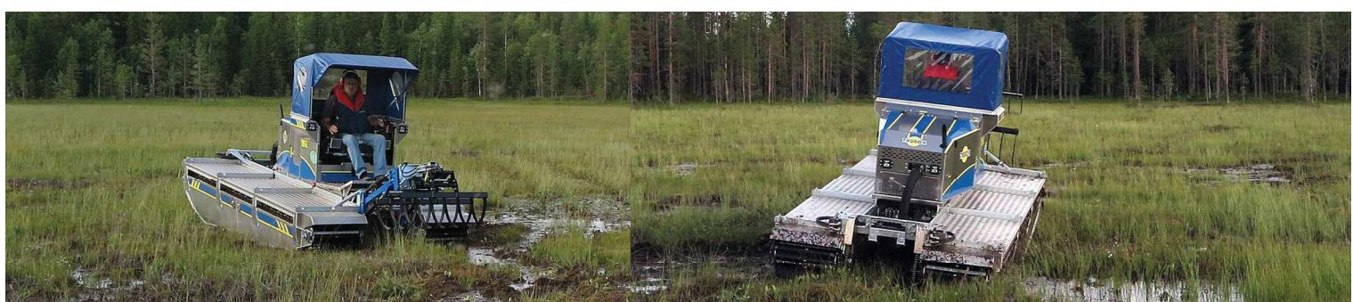
Truxor sustav raspodjele težine omogućuje minimalno opterećenje podloge čime se omogućuje rad na osjetljivim uvjetima.
