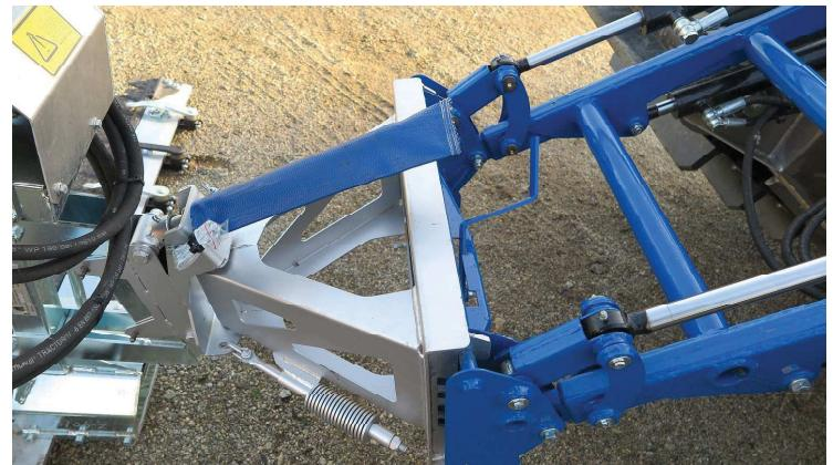
Poluautomatski brzi nosač X4 za brzu zamjenu alata.
