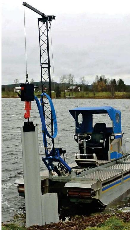
Uredaj DM 350 za nabijanje: sustav sa vitlom za podizanje i postavljanje plastičnih, drvenih i metalnih ploča. Hycon hidraulični čekić koji se koristi u kombinaciji sa DM 350 proizvodi snažne vibracije čime se postiže efikasno nabijanje u vodenim sredinama.
