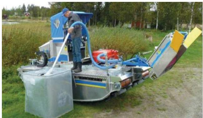
Uvjeti za čišćenje izljevanja nafte razlikuju se ovisno o okolišu. Tijekom zadnje faze rada obično postoje male površine nafte gdje je praktično skupiti naftu u mobilni spremnik. Spremnik Doro je montiran između pontona i isporučuje se sa spojnicama koje se lako montiraju na Sala rolo pumpu.
