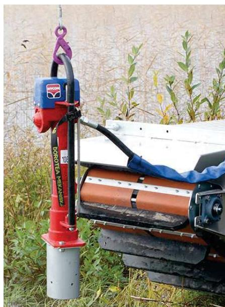
Hycon hidraulični čekić za nabijanje stupiće ili plastičnih ploča.
