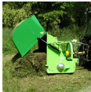
Scarico a terra mediante nr. 2 martinetti idraulici. Ground discharge by nr. 2 hydraulic rams.
