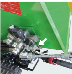
Regolazione velocità rullo. Roller speed regulated.
