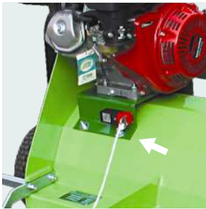
Interruttore di sicurezza azionato con una corda dall'operatore sulla moto. Safety switch with remote cord. Operated from driver seat.
