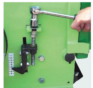
Regolazione di taglio millimetrica. Millimeter cutting adjustment.
