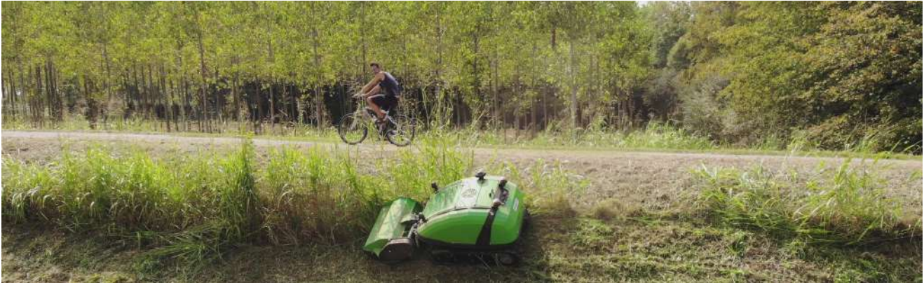
Cingolo con profilo basso. Low Profile Tracks. 40° Max
