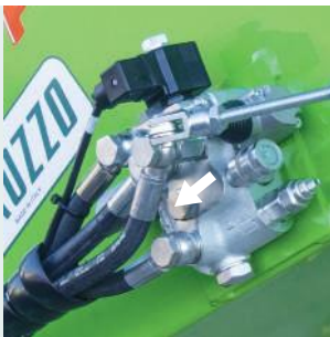
Regolatore velocità rullo. Roller speed controlling.
