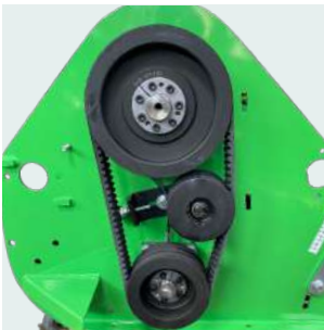
Tendinghia di facile regolazione con molla ad autotensionamento. Easy belts tightening with self-tensioning spring.
