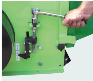
Regolazione di taglio millimetrica. Millimeter cutting adjustment.
