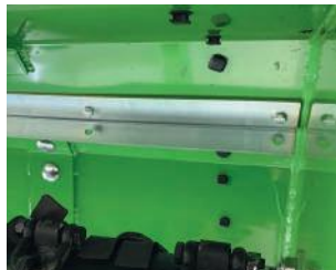
Lama mulching per alta riduzione dell'erba. Mulching metal bar for high grass reduction.
