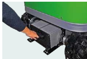
Batteria intercambiabile. Interchangeable battery. 10 kWh
