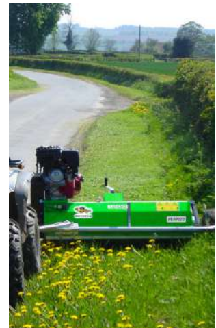
Spostamento laterale tramite timone di traino con attacco europeo. Lateral movement via towing drawbar with European attachment.
