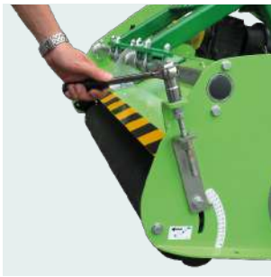
Regolazione di taglio millimetrica. Millimeter cutting adjustment.
