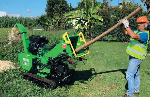
Ampia bocca di alimentazione. Wide Feeding hopper.
