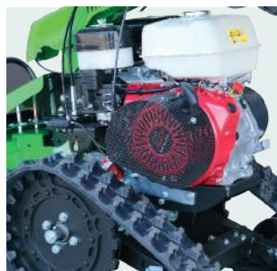
Protezione filtro aria. Air filter cover.
