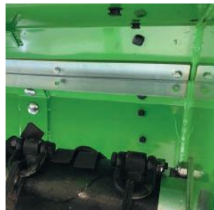
Lama mulching per alta riduzione dell'erba. Mulching metal bar for high grass reduction.
