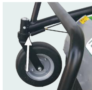
Bloccaggio ruote anteriori dalla plancia di comando. Front wheels locking from the dashboard.
