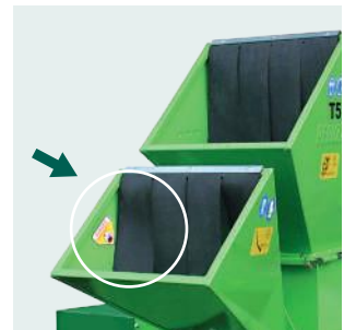
Tramoggia inserimento rami di grande diametro. Feeding hopper for large diameter branches.
