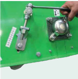
Regolazione di taglio millimetrica. Millimeter cutting adjustment.
