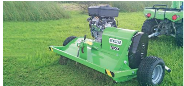
Spostamento laterale tramite timone di traino con attacco europeo. Lateral movement via towing drawbar with European attachment.
