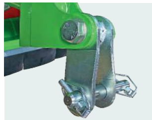
Snodo Sicurezza 3° punto. Safety joint on 3 point hitch.
