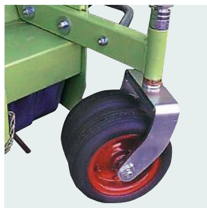
Regolazione dell'altezza di taglio su ruote frontali doppie. Height of cut adjustment on front castor double wheels.
