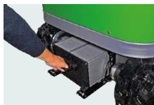
Batteria intercambiabile. Interchangeable battery. 10 kWh
