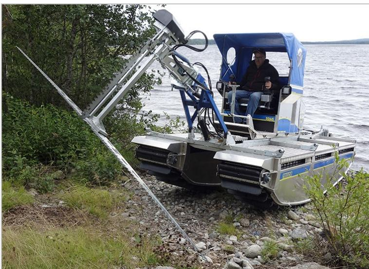
Hidraulični nosač za podešavanje nagiba je dodatna oprema stroja Truxor 5000.
