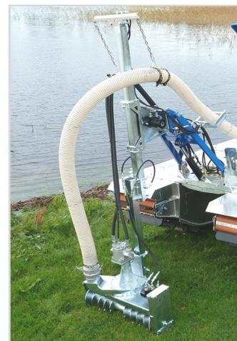
**Doro pumpa** ima hidraulični pogon. Vijak ubacuje talog u pumpu gdje se nalaze noževi koji omogućuju neprekidan protok taloga.
