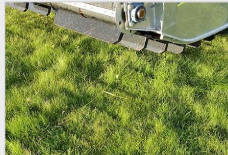
Truxor sustav raspodjele težine omogućuje minimalno opterećenje podloge. Truxor može voziti po travnjaku, a da pri tome ne ošteti travu.
