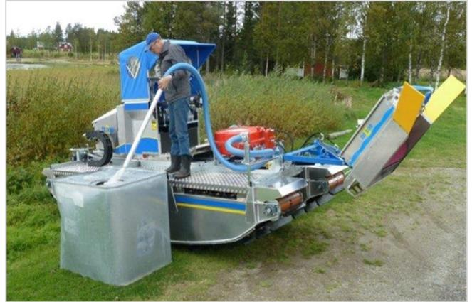
Kod završne faze rada, obično postoji manja površina ulja gdje je praktično koristiti mobilni spremnik. Spremnik je smješten između pontona i ima priključak za lakše priključenje Sala Roll pumpe. Sala Roll pumpa koristi se za pražnjenje spremnika pumpanjem ulja preko crijeva. Spremnik se koristi u kombinaciji sa Doro Skimmer 800.
