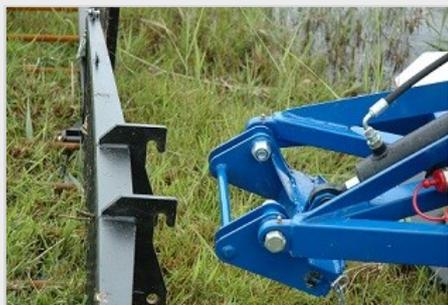
DM nosač alata za lakšu zamjenu priključaka.
