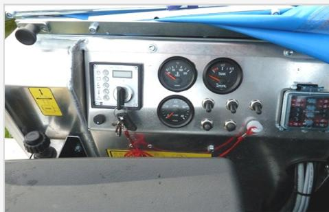
Na kontrolnoj ploči može se očitati tlak hidraulike, razina goriva, temperatura motora, temperatura hidrauličnog ulja, brojač radnih sati kao i broj okretaja motora.
