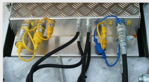
Brzi priključak hidraulike za radne alate. Upravljanje putem Joystick ručice on/off kao i max/min za brzinu rada alata.
