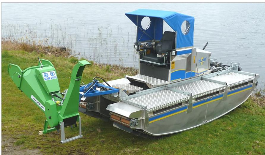
Ima ugrađena dva noža. Rotor uvlači materijal unutra, a protok zraka usmjerava materijal dalje kroz podešen izlaz. Radi uz pomoć hidraulike i na podesivom je nosaču, što olakšava rad na kosinama. Pokazao se koristan kod raščišćavanja močvara, jezera i kanala.
