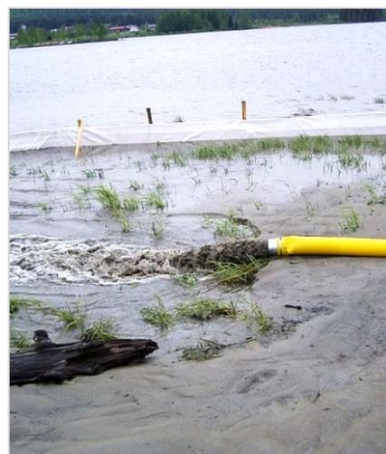
**Doro V3 pumpa** montirana na Doro Digger osigurava dobru kontrolu tijekom čišćenja od mulja. Sustav se sastoji od rotacijske glave sa noževima na usisnom dijelu koji omogućuje stalni dotok materijala u pumpu. Krilca na ulazu sprječavaju nepotrebno miješanje vode sa talogom.
