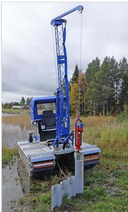
Uređaj DM 350 za nabijanje: sustav sa vitlom za podizanje i postavljanje plastičnih, drvenih i metalnih ploča.
