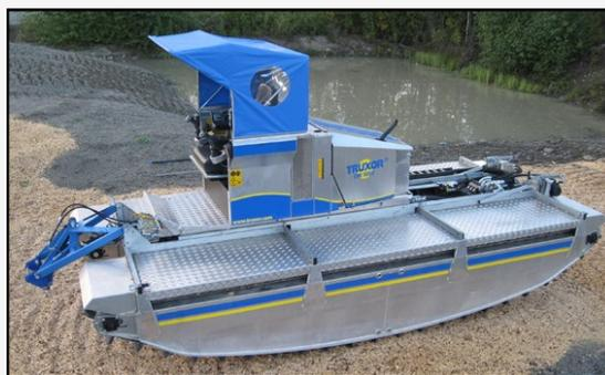
Pokretna kabina se hidraulički podešava i može poslužiti za balansiranje stroja (po principu kontra utega).
