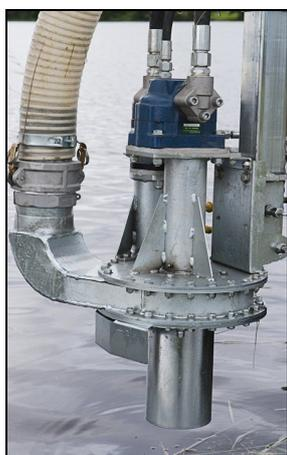
Za usisavanje čistog pijeska koristi se usisna cijev koja je montira na ulazu u pumpu (u tom slučaju se skine vijak). Usisna cijev je uključena u standardni set opreme.
