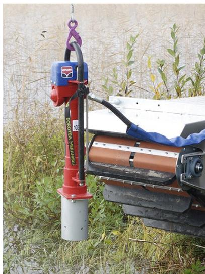
Hycon hidraulični čekić za nabijanje stupića ili plastičnih ploča. Može se koristiti sa ili bez uređaja DM 350, isporučuje se sa crijevima i brzim spojnicama.
