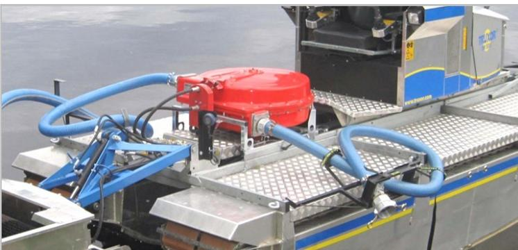
**Sala Roll pump** je pumpa pogodna za dekontaminaciju nepristupačnih zagađenih predjela. Usisna cijev može se postaviti na Doro Skimmer ili koristiti ručno. Uz pomoć Sala Roll pumpe može se usisavati ili ispumpavati materijal samo promjerom rotacije pumpe što je korisno u slučaju kada je spremnik spreman za pražnjenje. Jak vakuum osigurava dobru usisnu snagu. Sala Roll pumpa se može koristiti posebno sa usisnom cijevi ili u kombinaciji sa Doro Skimmer uređajem DS 800.
