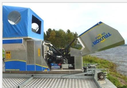
Kučiče motora sa poklopcem uz mogućnost otvaranja. Set alata nalazi se unutar kućišta.
